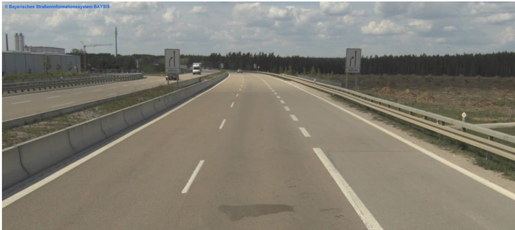
Bild 13: Überlagerung der Vorankündigung „Linkseinzug“ mit dem Einfädelungstreifen im Bestand
